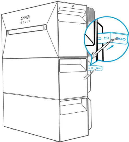
7. Verwenden Sie einen Kreuzschlitzschraubendreher, um die Kombi-Kreuzschlitzschrauben M5x10 an der L-förmigen Wandhalterung zu befestigen. Befestigen Sie dann die Verriegelungshalterung mit den Kombi-Kreuzschlitzschrauben M5x10 am Erweiterungsakku, um die Installation abzuschließen.
