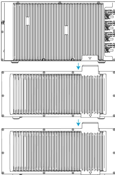
4. Befestigen Sie die L-förmige Wandhalterung an beiden Seiten des ersten Erweiterungsakkus unter der Solarbank mit Kombi-Kreuzschlitzschrauben M5x10.
