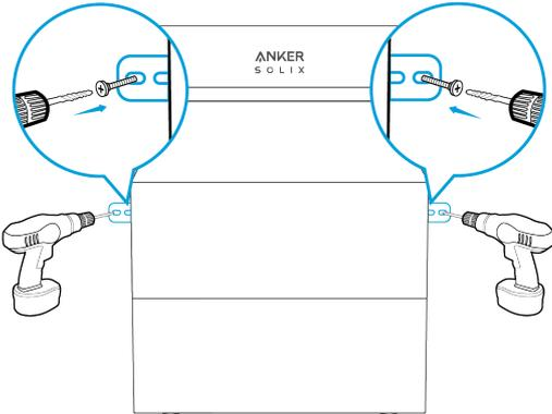
6. Klopfen Sie mit einem Hammer die Kunststoffhülse der selbstschneidenden Schraube M5x60 in das Loch, und verwenden Sie dann einen Kreuzschlitzschraubendreher, um die selbstschneidende Schraube M5x60 am L-förmigen Wandmontagebeschlag zu befestigen.
